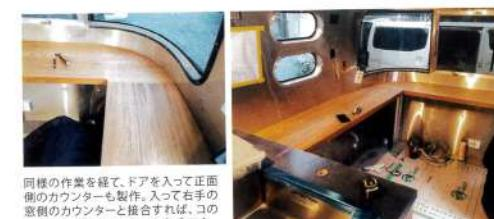
同様の作業を経て、ドアを入って正面側のカウンターも製作。入って右手の窓側のカウンターと接合すれば、ヨコの字型の大きなカウンターの完成です。
