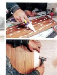
家具の外皮は、カウンター同様にチーク材をセレクト。フローリングとして使われる無垢のチーク材を手に入れ、貼面に貼り込んでいきます。
