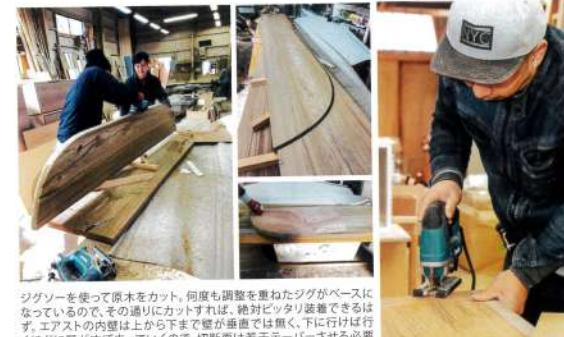
ジグソーを使って原木をカット。何度も調整を重ねたジグがベースになつないので、その通りにカットすれば、絶対ピッタリ装着できるはず。エアストの内壁は上から今まで壁が垂直では無く、下に行けば行くほどに壁がすぼまっていくので、切削面は若干アーバーさせる必要があります。エッジはサンダーで処理。
