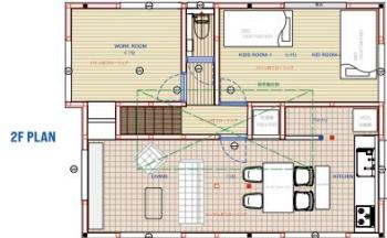
使用したい床材を落とし込んだ図面がチカラ。仕事場は背面を重視で温かいのプラン。2階の子供部屋などは北側で採光が弱いので、部屋が明るくなるようにクリアをチョイスしている。
